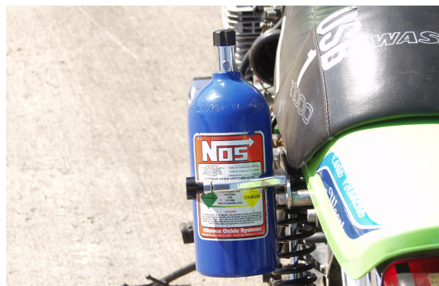
Foto: Lachgaseinspritzsystem an einem Motorrad
